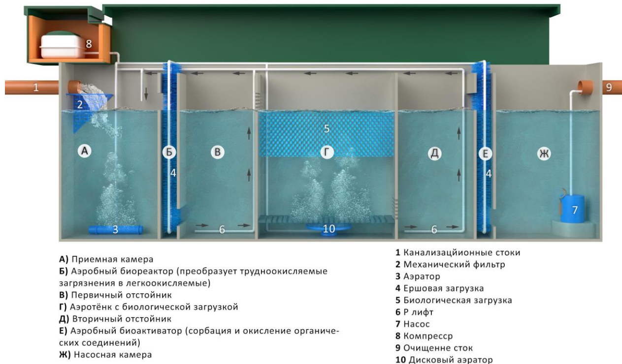
Рис. 1. Состав конструкции установки
